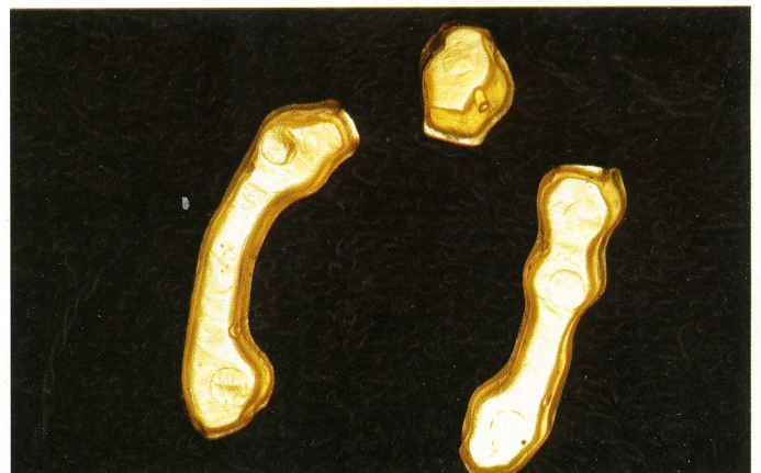
Fig.9 Detalle de las cofias de galvanoformación (secundarias o mesoestructura).
